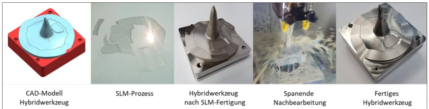
Bild 3: Fertigungsschritte der hybridgefertigten Auswerferseite.
