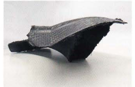
Die so genannte «Perform» vor der Injektion des Harzsystems.
