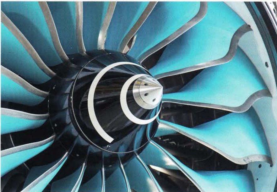
Das weiße Blech zwischen den Turbinenschaufeln nennt sich «Filler» und stellt die optimale Strömung sicher. Das an der HSR neu entwickelte Bauteil ist aus modernen Verbundwerkstoffen hergestellt.
