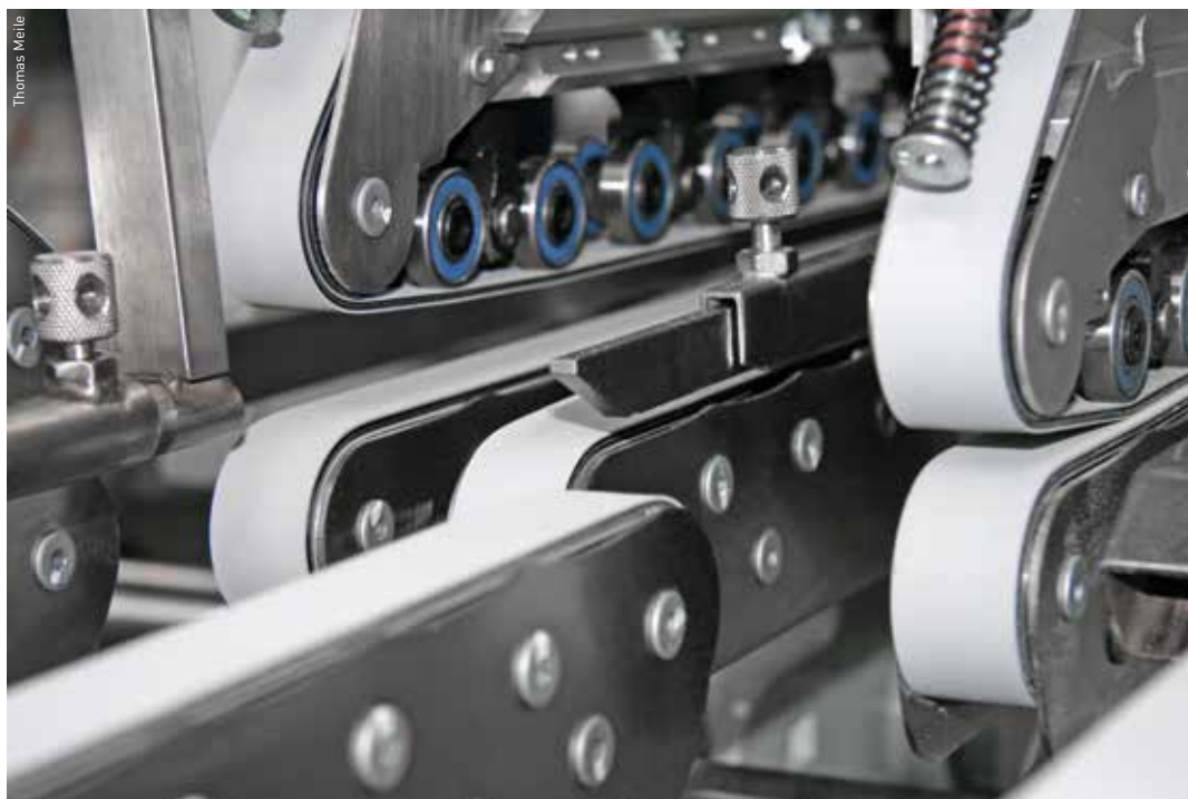
Der Flachriemen läuft über Pulleys und ändert dabei seine Richtung. Die dabei auftretenden Wärme- bzw. Energieverluste lassen sich mit geeigneten Massnahmen vermindern.
