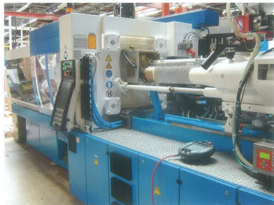
Mit dieser Spritzgussmaschine stellt Greiner Packaging AG in Diepoldsau/SG Kaffeebecher aus Kunststoff her. (Fotos: Greiner Packaging)
